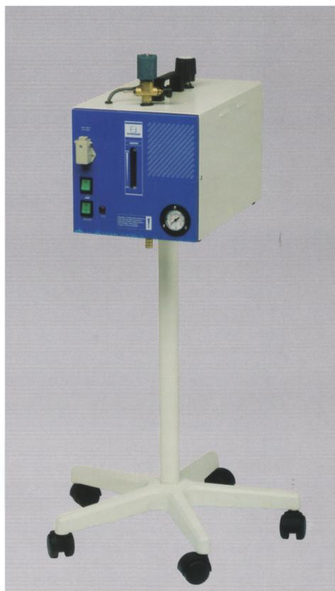
Générateur de vapeur industriel avec chaudière ronde 5 litres, pressostat pour contrôle exact de la pression de la vapeur, contrôle visuel du niveau d'eau dans la chaudière, soupape à bille pour le déchargement de l'eau et des dépôts, électrovanne avec la régulation du flux de vapeur, soupape de sécurité, N°2 thermostats de sécurité à protection de la résistance en cas de manque d'eau et à protection de la chaudière en cas de surtempératures.
